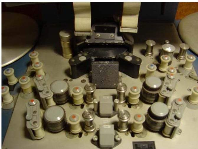
Obr. 14. Plochý stříhový stůl značky Steenbeck
