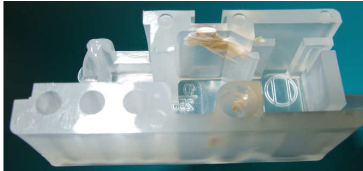
Obr. 73. Vady tělesa MKO – nečistoty.
