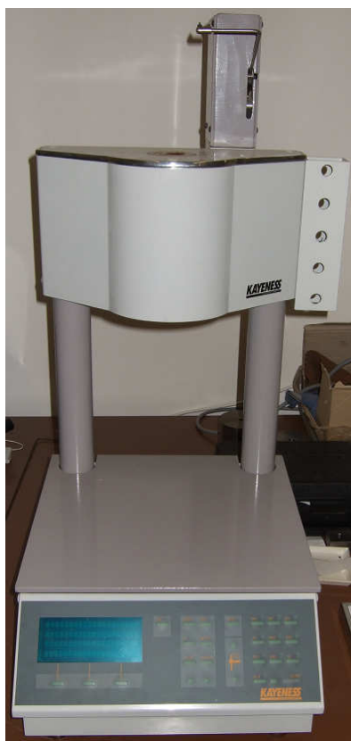
Obr. 47. Výtlačný plastometr Dynisco Kayeness LMI 4003.
