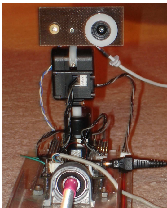
Obr. 1 Sestavený dálkoměrný modul umístěný na kalibrační stanici
