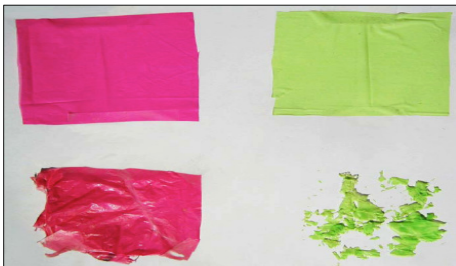
Obr. 5. Polyethylenové filmy bez (vlevo) a s (vpravo) TDPA TM před (horní) a po (dolní) 10 měsíční inkubaci na skládce odpadů [23].
