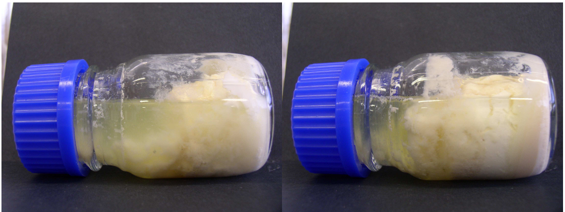
Obr. 7 Modelové vzorky jogurtů s použitím ióta karagenanu při 37 °C (vlevo) a 42 °C (vpravo)
