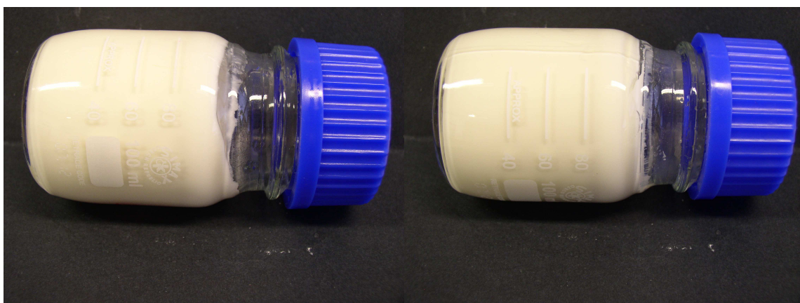
Obr. 20 Modelové vzorky jogurtů s použitím kappa karagenanu při 37 °C (vlevo) a 42 °C (vpravo)
