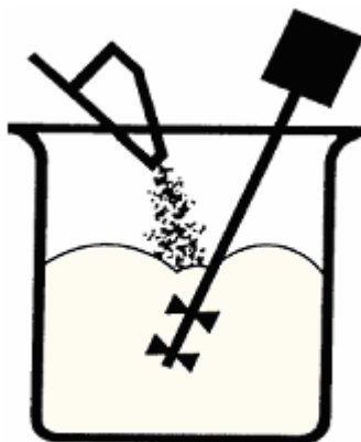
Obrázek 11 Přídavek karagenanů po částech a za stálého míchání [39]
