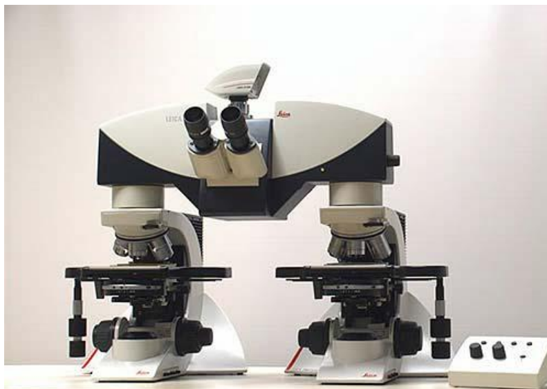
Obrázek 30: Komparační mikroskop typu Lecia FS CB [13]
