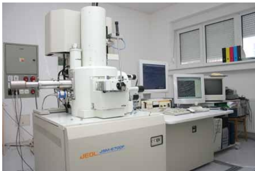
Obrázek 31: Elektronový rastrovací mikroskop JSM-6700F s ultravysokým rozlišením [13]
