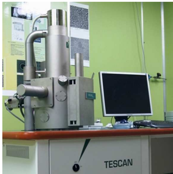
Obrázek 28. Skenovací elektronový mikroskop Vega-II LMU [44]
