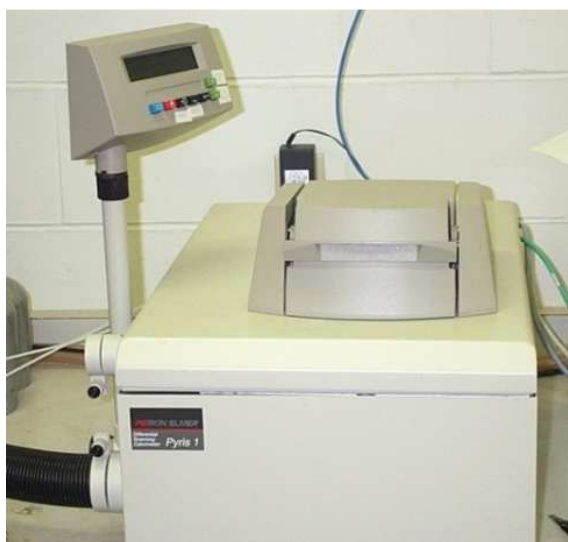
Obrázek 24. Diferenciální skenovací kalorimetr Perkin-Elmer Pyris 1
