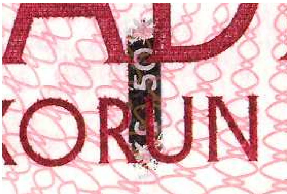
Obrázek 24. – ukázka tisku hlubotiskové litery a ofsetových linií na pravé bankovce přes ochranný proužek.
