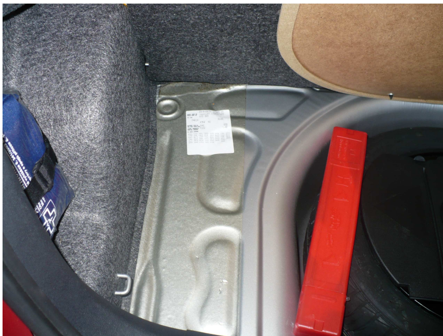
Obr. 35. Umístění datového štítku ve vozidle Škoda Fabia
