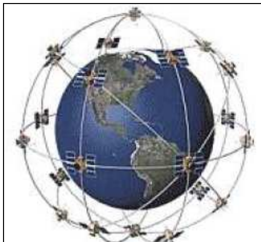
Obr. 9. Dráhy družic NAVSTAR [13]
