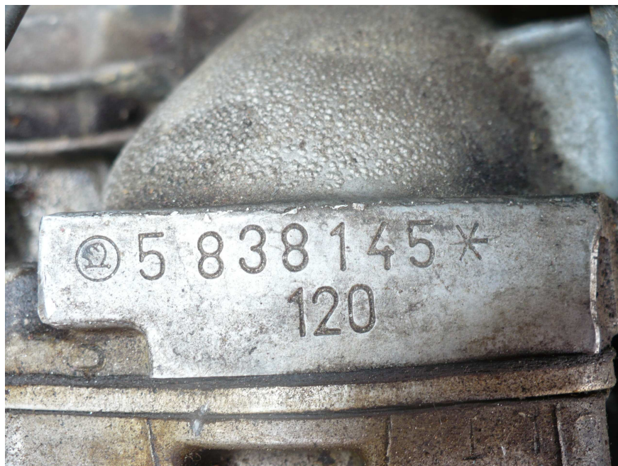
Obr. 24. Číslo motoru (nahore), spolu s označením typu motoru vozidla Škoda 120L
