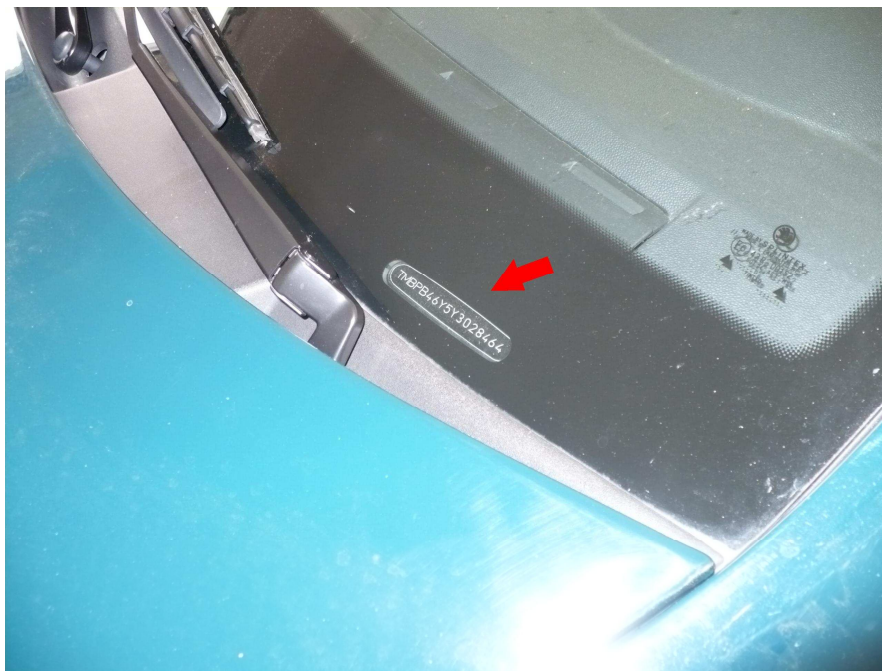
Obr. 27. Umístění identifikačního čísla VIN na čelním skle
