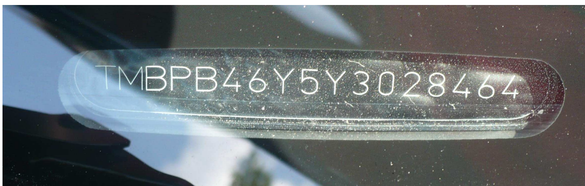
Obr. 26. Identifikační číslo VIN na čelním skle vozu Škoda Fabia
