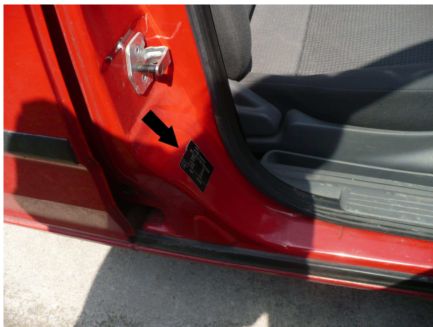
Obr. 39. Umístění identifikačního štítku na voze Opel
