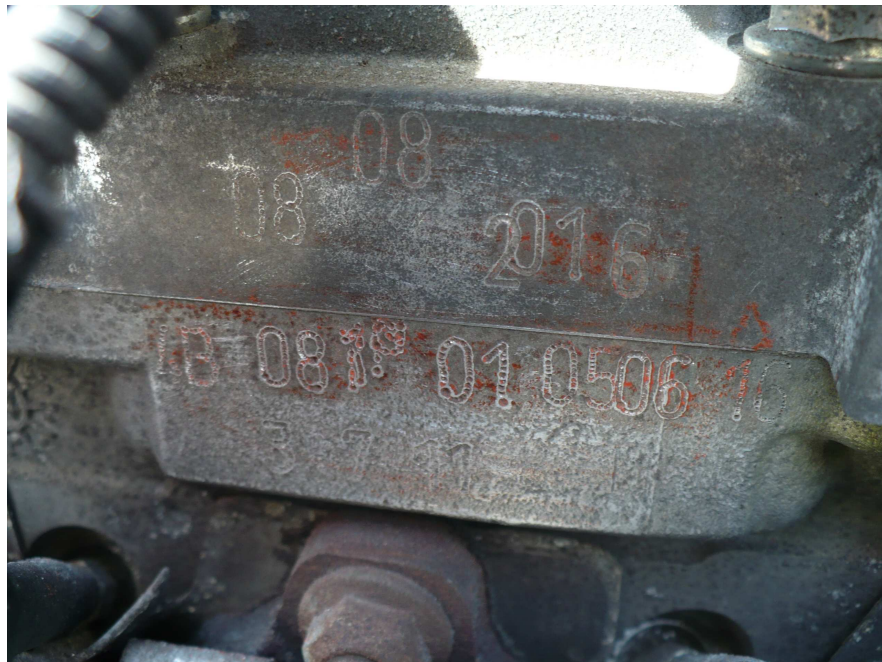
Obr. 41. Typové označení a výrobní číslo motoru vozidla Opel
