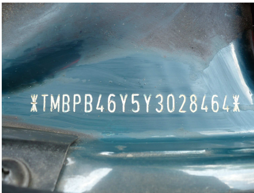
Obr. 28. Identifikační číslo VIN vyražené v motorovém prostoru vozu Škoda Fabia
