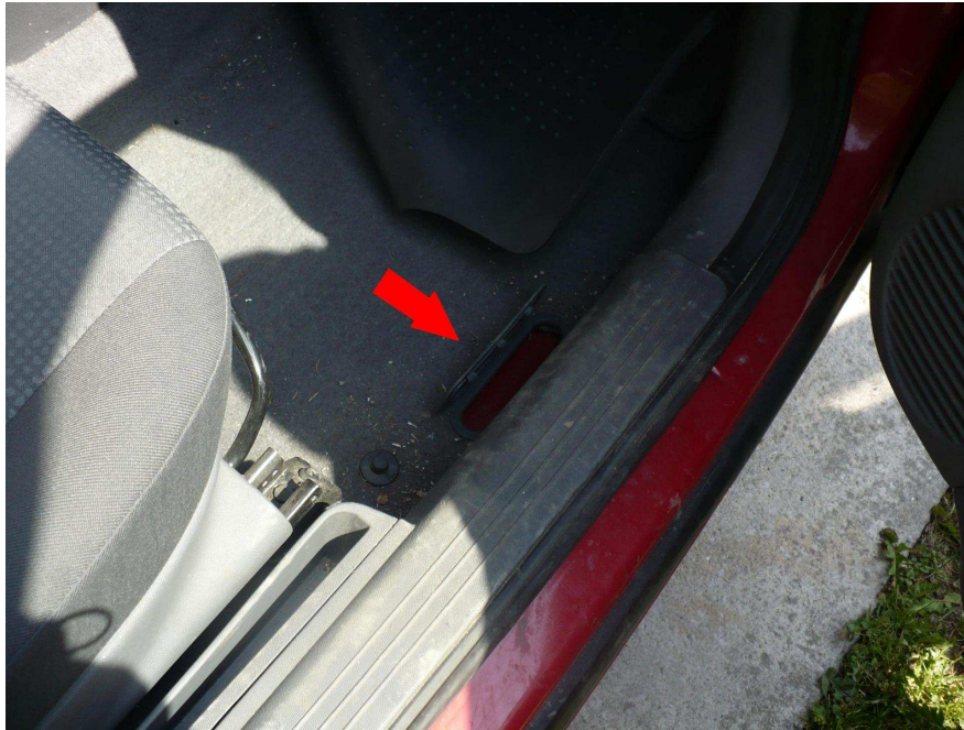
Obr. 38. Umístění identifikačního čísla VIN ve voze Opel
