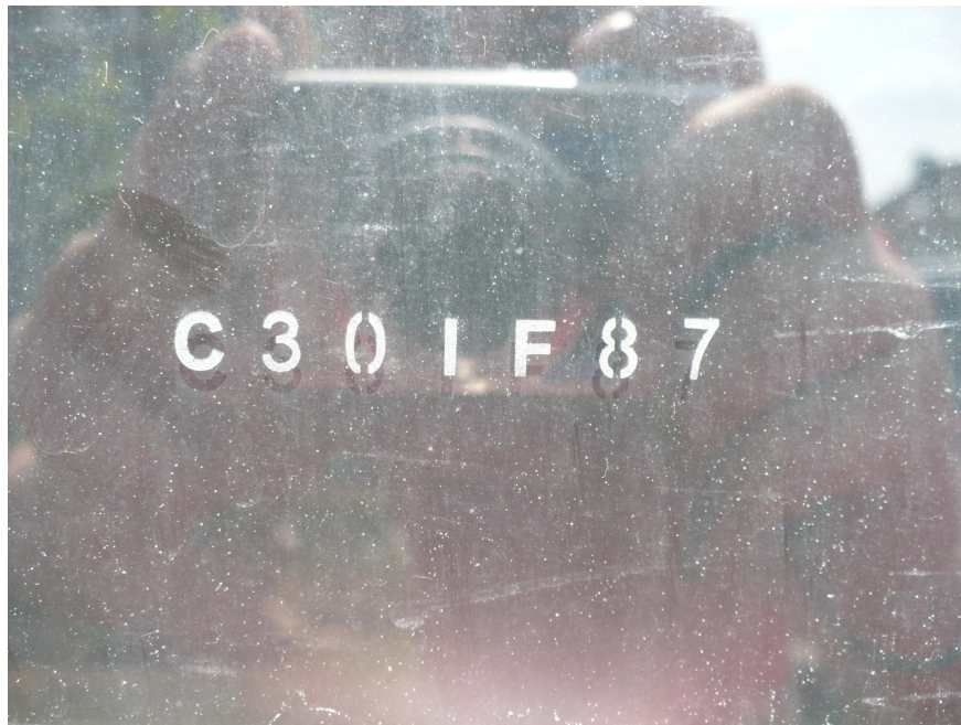
Obr. 45. Sedmimístný alfanumerický kód nanesený na skle, pomocí metody pískováním tzv., systém SBZ OCIS
