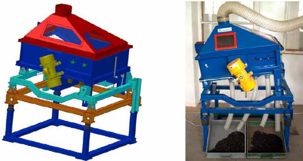
Obrázek 3 - Příklad linky fluidní separace, AQUATEST a.s.[8].
