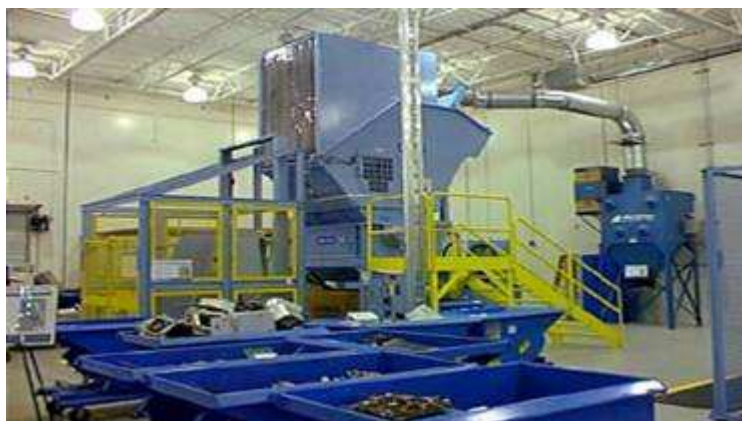
Obrázek 5- Příklad linky gravitačního splavu, Vitaro s.r.o.[10]
