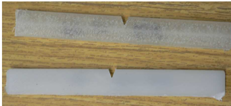
Obr. 51. Zrušení tělíska pro zkoušku rázové houževnatosti
