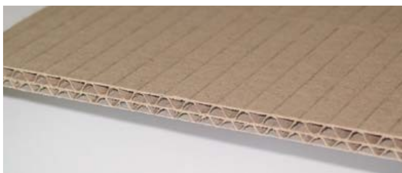
Obr.2. Pětivrstvá vlnitá lepenka obsahující vlnu typu B a C.
